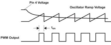
Figure 13. Soft-Start Circuit
